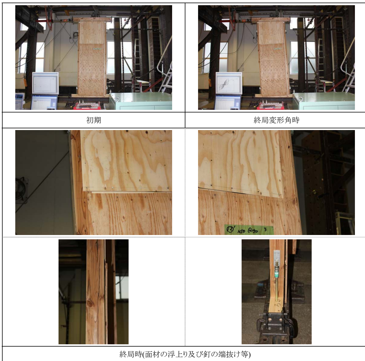
図 5-15 B-1e 損傷写真
